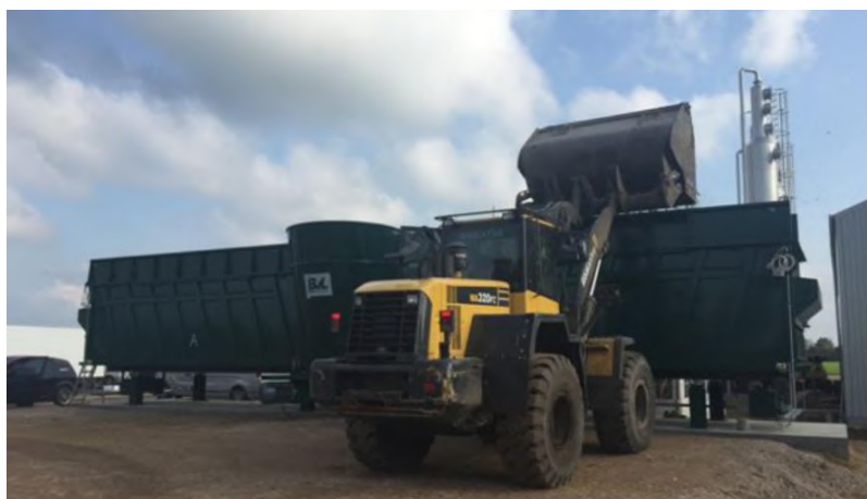
Figur 2.6: Eksempel på uden-dørsopstillet faststofindtag (indfoderanlæg), som fyldes med frontlæsser. Produkt V-Bio Combi 2D.
